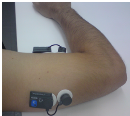
Figura 5.31: Posicionamento dos sensores eletromiográficos nos grupos musculares bíceps brachii e tríceps brachii .
