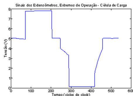
Figura 5.4: Extremos de operação do sensor de força instrumentado na célula de carga.
