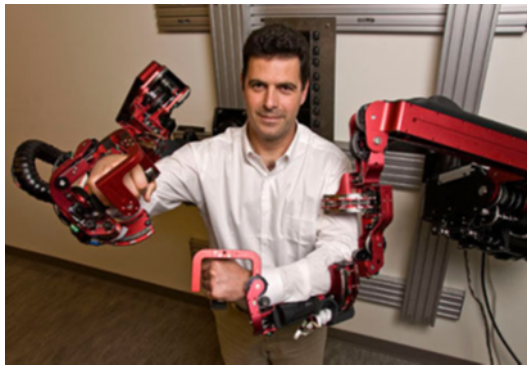
Figura 2.1: Exoesqueleto para membro superior com 7 graus de liberdade: CADEN-7 (extraído de (PERRY; ROSEN; BURNS, 2007))
