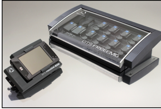
Figura 5.27: Sondas para captação de sinal EMG (direita) e unidade móvel receptora wi-fi (esquerda).
