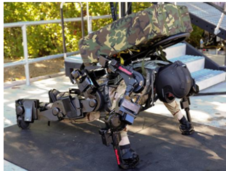
Figura 2.5: Exoesqueleto para amplificação da capacidade humana - Raytheon's Sarcos (extraído de (KARLIN, 2011)).
